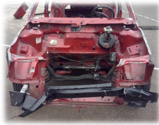
Deformación en pieza reacondicionada
