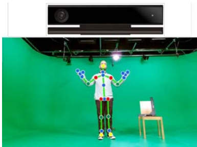
Figura 4. Sensor Kinect (imagen superior) y esqueleto obtenido por el sensor (imagen inferior)
